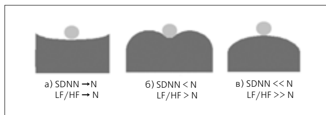
Рис. 7. Геометрическая интерпретация устойчивости: а) устойчивое состояние; б) устойчивое в малом, но неустойчивое в большом; в) неустойчивое состояние, N — условная норма.
