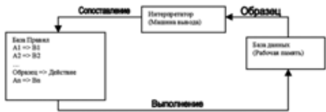
Рис.1. Принцип работы ЭС.
