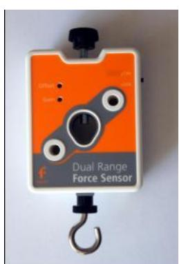
При виконанні дослідження використовується мобільна лабораторія NOVA5000 з датчиком сили DT272 та датчиком відстані DT020-1
