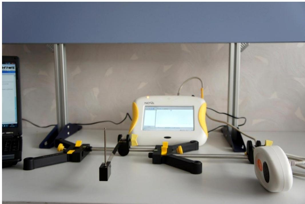
19. Від'єднайте датчик сили та під'єднайте датчик відстані до першого виходу реєстратора даних I/O-1.
