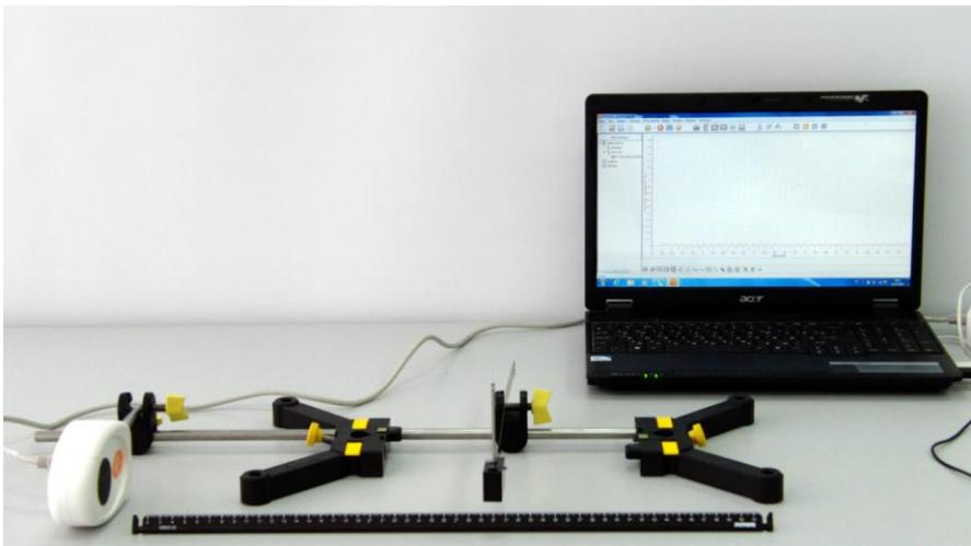
19. Від'єднайте датчик сили та під'єднайте датчик відстані до першого виходу реєстратора даних I/O-1.
