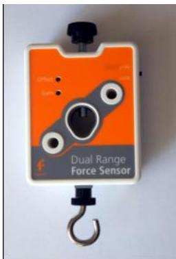
Це популярний дводіапазонний силовий датчик, який здатний вимірювати сили. Датчик має два діапазони дії:  $\pm 10$  Н або  $\pm 50$  Н. Він легко кріпиться на штативі або ж застосовується як пружинні терези.
