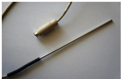
Датчик температури (-25 °C – 110 °C) може під'єднуватися до реєстраторів даних Nova5000, MultiLogPRO або TriLink. Датчик температури є простим, надійним датчиком із нержавіючої сталі. Він під'єднується безпосередньо до
