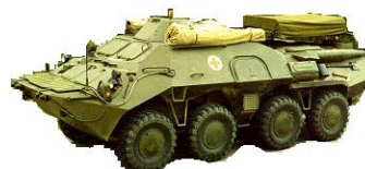
бронированная медицинская машина БММ-1 «Симфония»
