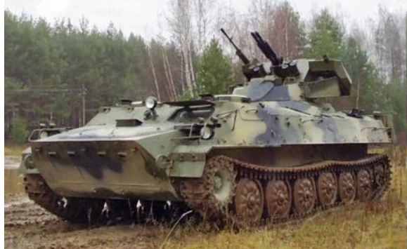
Боевая машина МТ-ЛБМ 6МБ3 с 23-мм пушкой ГШ-23 и 12,7-мм пулеметом КОРД.
