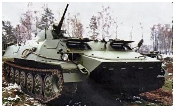
МТ-ЛБМ 6МА с 14,5-мм пулеметом КПВТ
