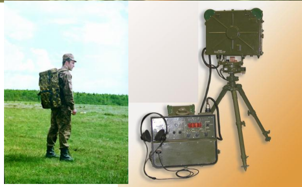
Радиолокационная станция ближней разведки СБР-3
