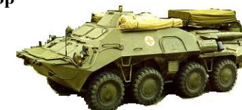
бронированная медицинская машина БММ-1 «Симфония»
