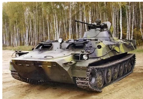
Машина МТ-ЛБМ 6МБ с 30-мм пушкой 2А42
